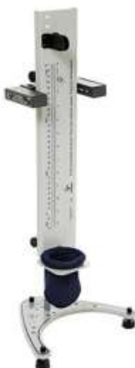
Figura 1 – Aparelho utilizado para demarcar as distâncias de percurso da esfera com os sensores fotossensíveis.
